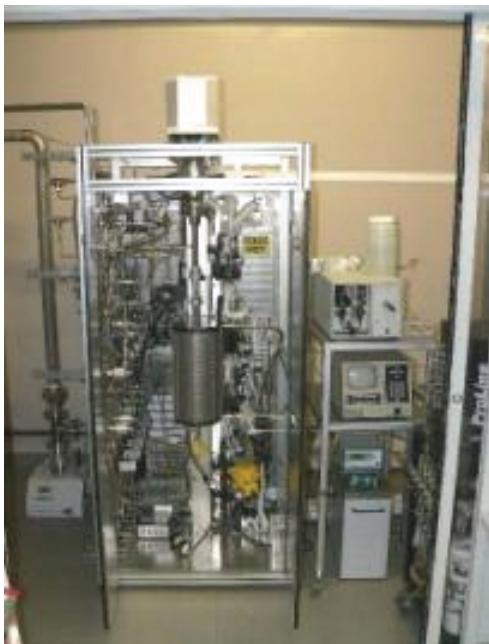
*Equipo basado en un microbalanza de Rubotherm para la caracterización de adsorbentes, (cortesía de Carburos Metálicos).*
