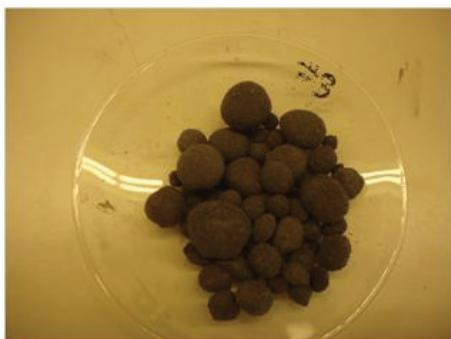
*Agregados centimétricos de ceniza volante de incineradora después del tratamiento de carbonatación acelerada (cortesía de Frederic Clarens, CTM).*
