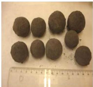
21. Carbonatación de cenizas de incineradoras de residuos urbanos para la encapsulación de metales y reducción de alcalinidad mediante carbonatación (para reducir la toxicidad de las cenizas de incineradoras).
