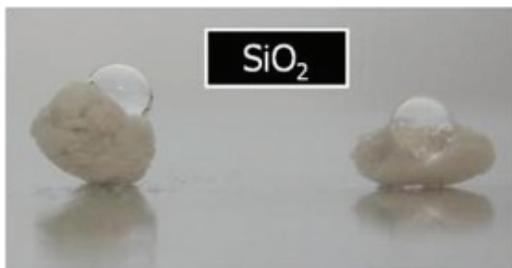
Muestra del comportamiento hidrofóbico de la perlita silanizada
