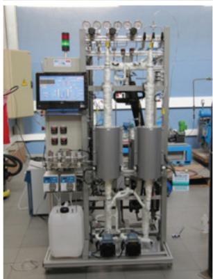
Líquidos iónicos sintetizados (arriba). Reactor de adsorción de CO<sub>2</sub> (abajo), capaz de realizar ciclos de adsorción-desorción por cambios de presión, temperatura o composición química (cortesía de Carburos Metálicos).
