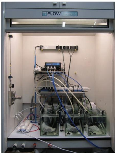
Vista general del sistema experimental correspondiente a los ensayos realizados para controlar el macrofouling mediante la acidificación del agua con CO<sub>2</sub> (cortesía de MATGAS 2000 AIE e IBERDROLA).
