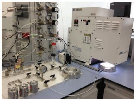
*Fotoreactor diseñado y construido para la evaluación de catalizadores en la transformación del CO<sub>2</sub> en productos de alto valor añadido.*
