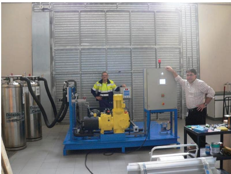
*Equipo de suministro de CO<sub>2</sub> a alta presión (300 bar) desarrollado en el proyecto para el espumado de plástico (cortesía de MATGAS 2000 AIE y LINPAC).
